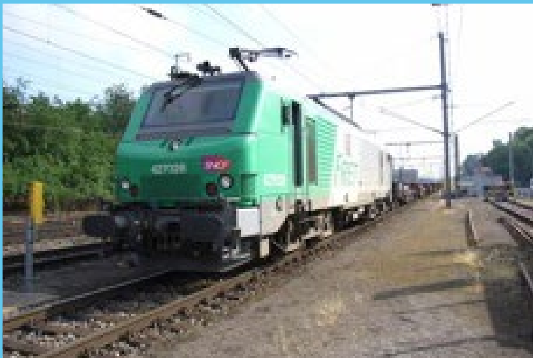
Les BB27000 ont remplacé les anciennes machines monophasées circulant sur l'artère Nord-Est
